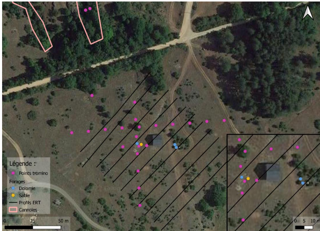
Figure 12 : Carte d'acquisition des données tromino sur le site de l'observatoire du Larzac.
